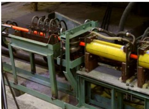
Секционное построение позволяет гибко подходить к построению линий индукционного нагрева для различных технологических процессов
